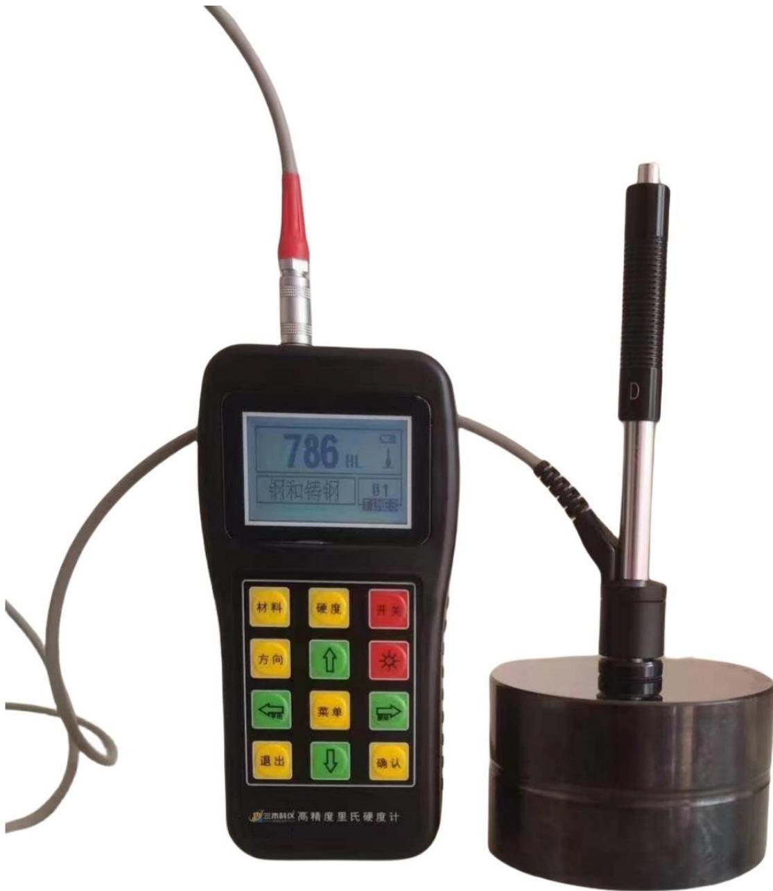
**产品概述：**HL180A 里氏硬度计是一种塑壳经济实用型一体化硬度测试仪器，主要适用于测试金属材料的硬度，具有测试精度高、体积小、操作容易、携带方便，测量范围宽的特点。HL180A 里氏硬度计是以里氏硬度为原理，测出里氏（HL）硬度值经过程序自动转换成布氏，洛氏，维氏，肖氏等硬度值，还可以配置各种测试配件，来满足于各种测试条件和环境，主要适用于金属材料的快速硬度测试，特别适宜对大型零部件及不可拆卸部件的现场硬度测试。
